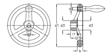
b = 28 d1 = 315 d2 H7 = 26 d3 = 53 d4 = M 12 Handle  $\overline{\phantom{0}}$  = 32 l1 = 33 l2 = 56
